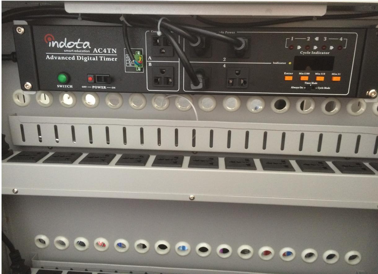
Die Parotec Trolley-Zeitschaltuhren sind mit 3 Einstellungen ausgestattet. 'Immer eingeschaltet', 'Timer-Modus' und 'Zyklus-Modus'.
